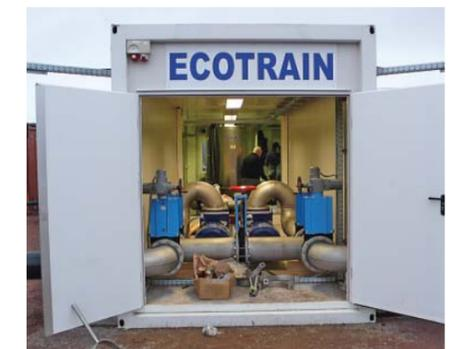
КОНТЕЙНЕРЫ С УСТАНОВЛЕННЫМ ОБОРУДОВАНИЕМ ДЛЯ ЗАПОЛНЕНИЯ ГЕОТРУБ
