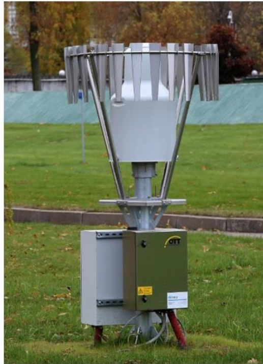
Рисунок 2. Установленный осадкомерный комплекс.
